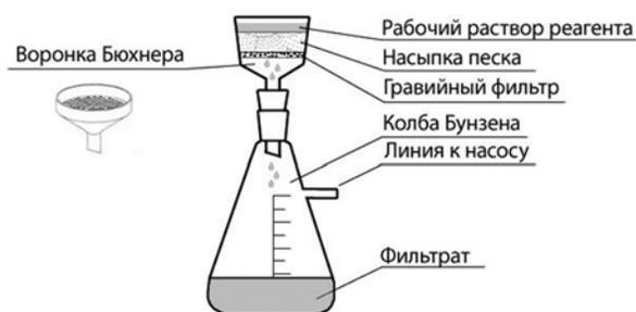
**Рисунок 2 – Установка для фильтрации под вакуумом**
