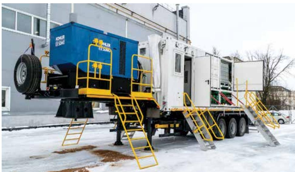
**Рисунок 1 – Установка дозирования химреагентов УХР6**
