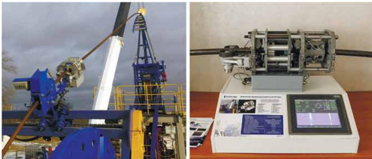
Определение реального состояния гибкой насосно-компрессорной трубы на всех этапах её использования
