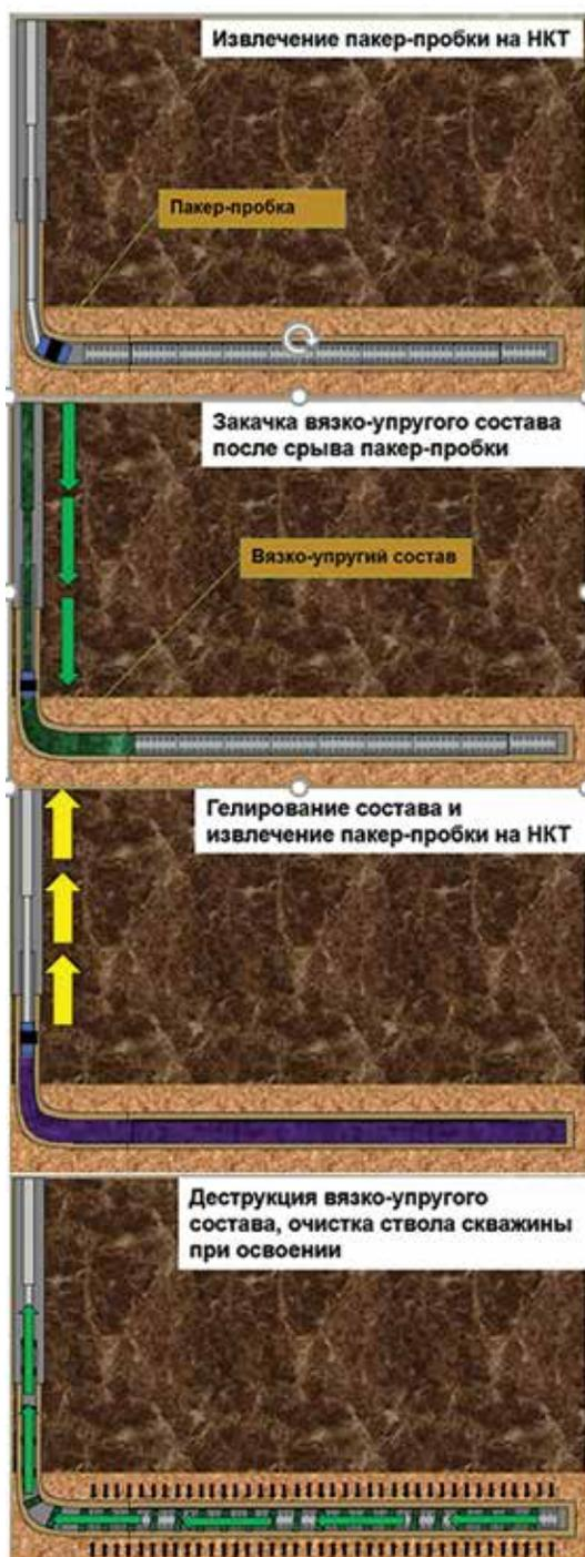
**Рисунок 5 – Схема технологии безопасного извлечения пакер-пробки на НКТ с применением программируемого вязкоупругого состава**
