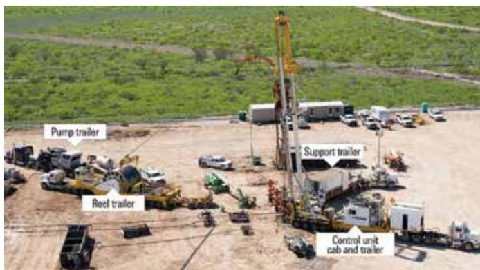
Инжектор с электрическим приводом и ГНКТ диаметром 66,68 мм (2 5/8 дюйма) позволили произвести работу на скважине с рекордной протяженностью бокового ствола в сланцах Eagle Ford.
