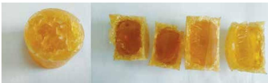
**Рисунок 3 – Образцы из эпоксидной смолы после испытаний в ультразвуковом анализаторе прочности**
