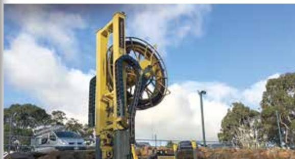
MinEx CRC использует технологическую платформу для колтюбингового бурения RoXplorer, разработанную DET CRC и прошедшую полевые испытания в Неваде в 2018 году. Технология разработана для разведочного бурения новых месторождений полезных ископаемых с низкими затратами на глубину до 500 м и весом установки менее 10 т.
