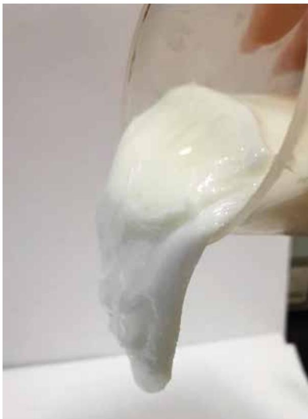
**Рисунок 1 – Внешний вид геля после смешения рабочего раствора с водой**
