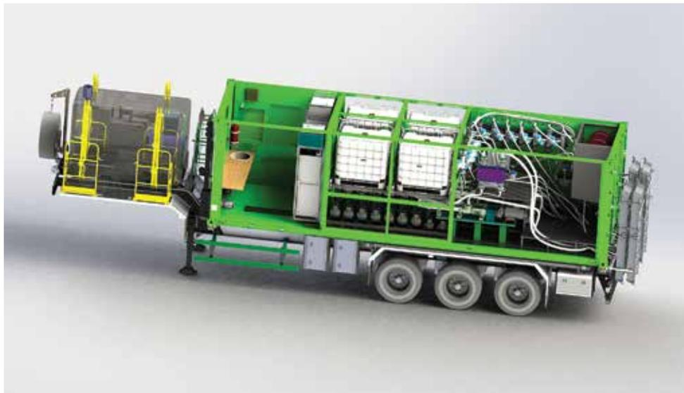
**Рисунок 2 – Установка дозирования химреагентов УХР6**
