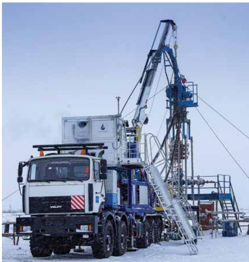
**Все больше ремонтов происходит с использованием колтюбинга, поскольку эта технология позволяет более щадяще отнестись к скважине, когда, например, нужно удалить песчаные пробки или проделать какие-либо другие манипуляции. Все они проводятся без глушения скважины, и, соответственно, призабойная зона пласта ничем не засоряется, коллекторские свойства не нарушаются, параметры не усугубляются.**
