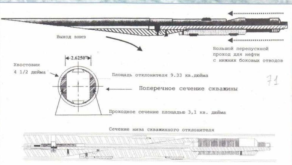
Скважинный отклонитель с выходом вниз TIW 4-1/2"
