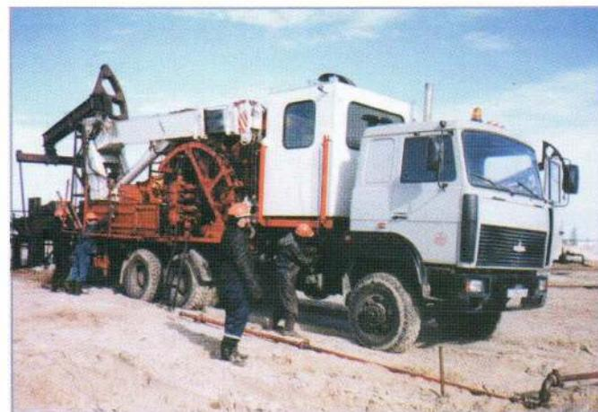
**Колтюбинная установка ФИД М1001 на скважине в Сургуте**
