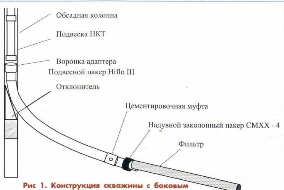
Рис 1. Конструкция скважины с боковым стволов при использовании заколонных пакеров
