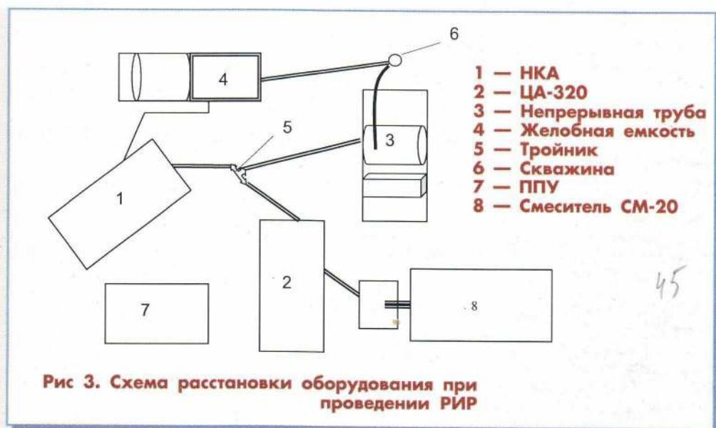
**Рис 3. Схема расстановки оборудования при проведении РИР**
