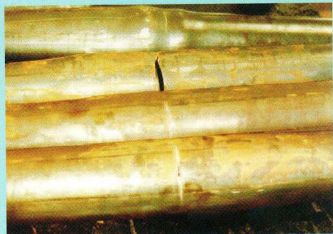
Рис. 4. Усталостные разрушения труб при лабораторных испытаниях
