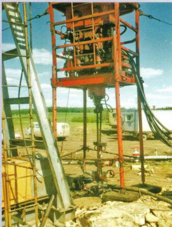
Рис. 3. Монтаж инжектора установки M1002 с диаметром трубы 25,4 мм для ремонта скважин по межтрубному пространству Fig. 3. The installation of M1002 injector with tubing O.D. 25.4 mm for well servicing via annular space.
