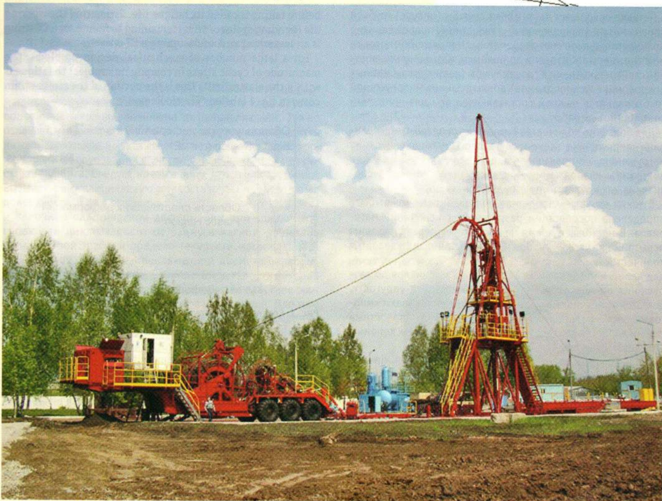
Колтюбинговый комплекс на базе М4001 / Coiled Tubing complex on base of М4001 CT unit
