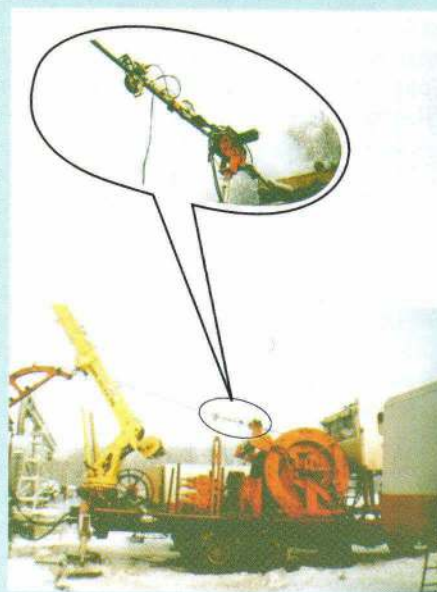
Рис. 4. Расположение датчика контроля глубины при проведении геофизических работ с колтюбинговым агрегатом Fig. 4. The layout of depth control sensors on coiled tubing unit while logging
