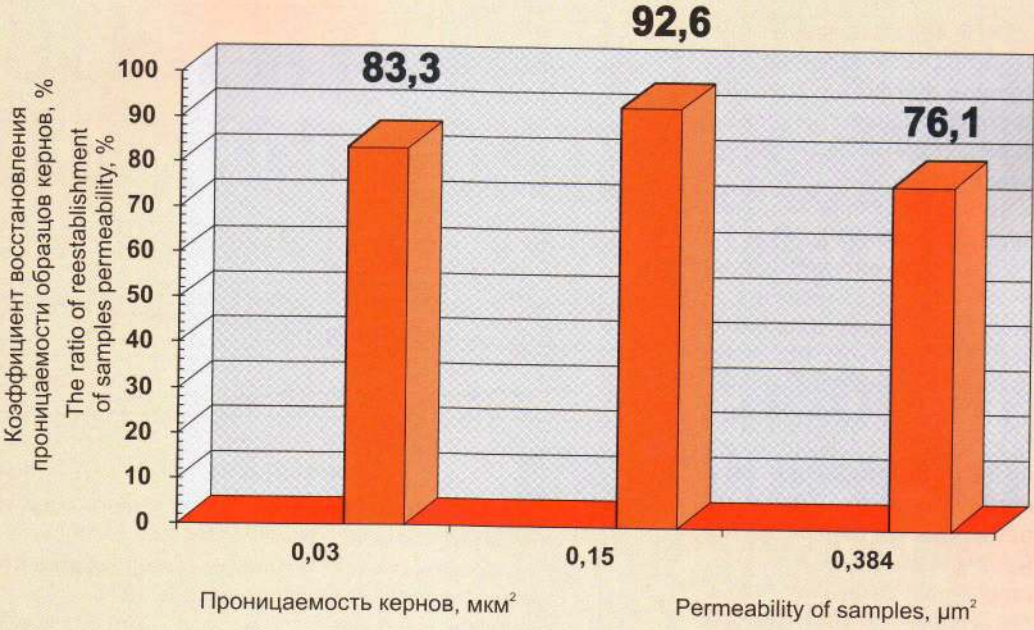
Рис. 3. Результаты восстановления первичной проницаемости образцов кернов после фильтрации через них блокирующих жидкостей фирмы «Clear Water»
