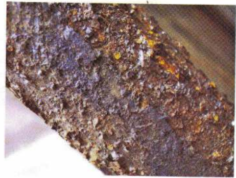
Участок колтюбинга на барабане. На рисунке показана характерная разрастающаяся область коррозии. Второй виток на барабане.
