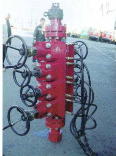
Плашечный превентор ППЛ-80-35 производства ЗАО «НПП Сибтехноцентр» NPP Sibtechnocenter ram-type blowout preventor PPK-80-35
