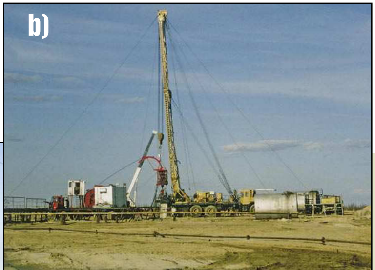
Рис. 2. Схема расстановки оборудования при проведении работ по отрезанию прихваченных НКТ: а) скважина № 8318, б) скважина № 1276
