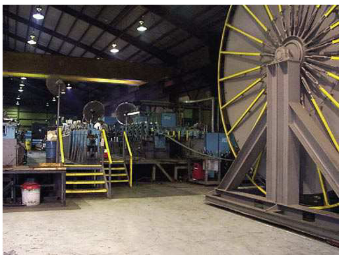
Рис. 1. Плоская стальная полоса (штрипс), подающаяся в стан Fig. 1. Flat Strip Feeding into Mill
