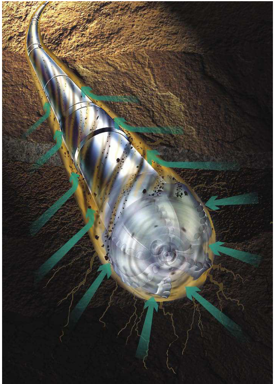
Рис. 1. Течение бурового раствора в стволе скважины при бурении с отрицательным перепадом давления
