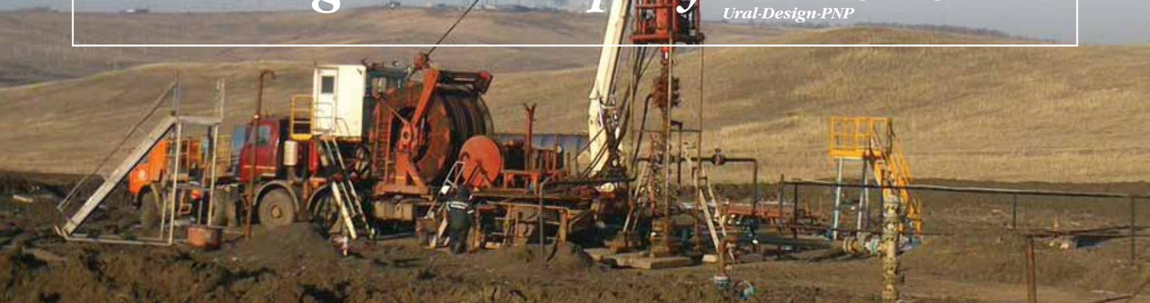
ООО «Урал-Дизайн-ПНП» с 2012 года успешно выполняет работы по фрезерованию фрак-портов в трехстадийной компоновке Stage FRAC с применением колтюбинговой установки.
