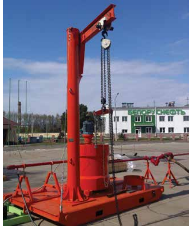
Рисунок 2 – Кабельный инжектор производства ООО «Псковгеокабель»
