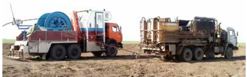
Рисунок 2 – Освоение фонтанной скважины в Самарской области, ПКС-3,5Э с ГСПТ 38 мм. Глубина скважины 3100 м, глубина спуска ГСПТ 2150 м, рабочее давление 150 атм., отбор жидкости 65 м 3 (ООО «Нефтесервис-НН»)
