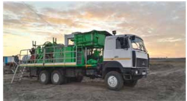
**Рисунок 1 – Установка для струйного вскрытия пласта СВПП**
