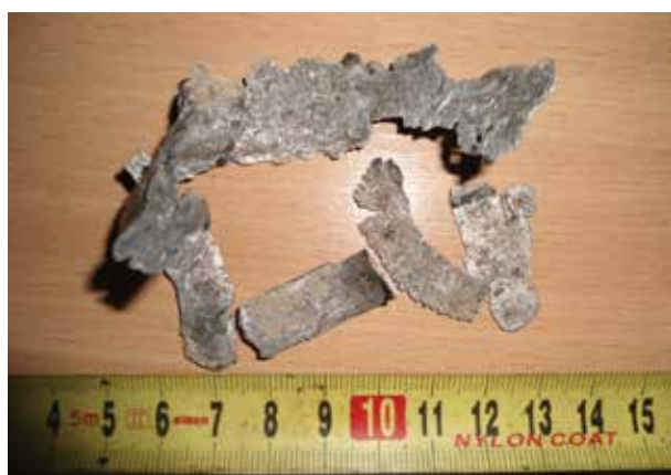
Рисунок 9 – Результат ошибок при подготовке скважины
