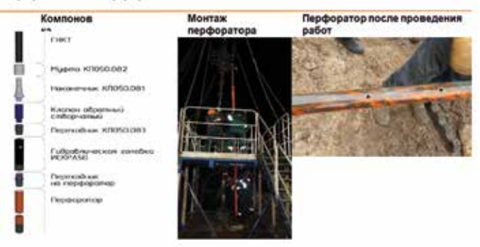
Кумулятивная перфорация на ГНКТ
