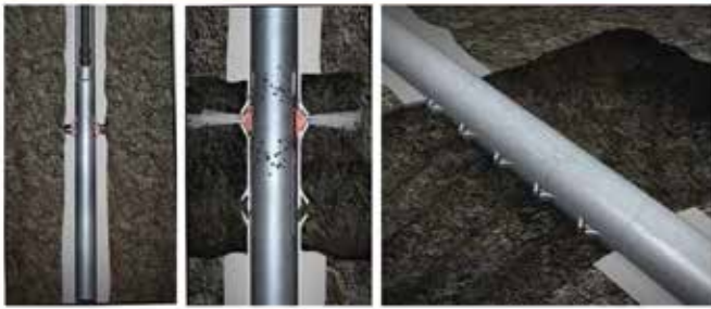
Перфорация колонны и намыв каверн
