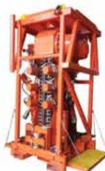
Coiled Tubing Injector Инжектор ГНКТ
