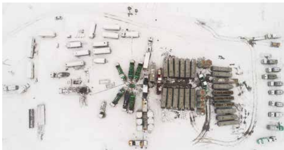
Рисунок 3 – Расстановка оборудования на скважине 310g Figure 3 – Equipment placement on well 310g
