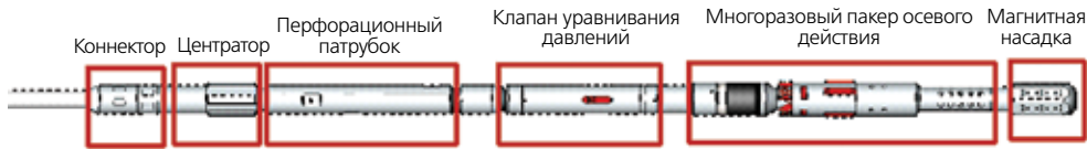
Рисунок 2 – Пакерная система Raptor – общая информация
