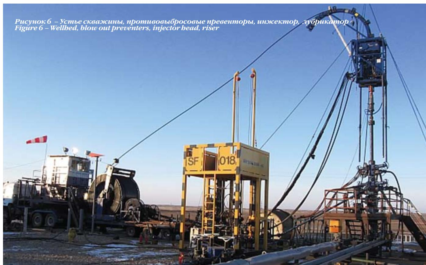
Рисунок 6 – Устье скважины, противовыбросовые превенторы, инжектор, лубрикатор
