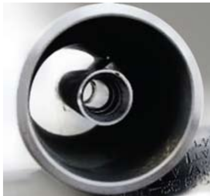
Рисунок 3 – Приемное гнездо полированного штока для стыковочного переводника Figure 3 – The polish-bore receptacle for the stinger
