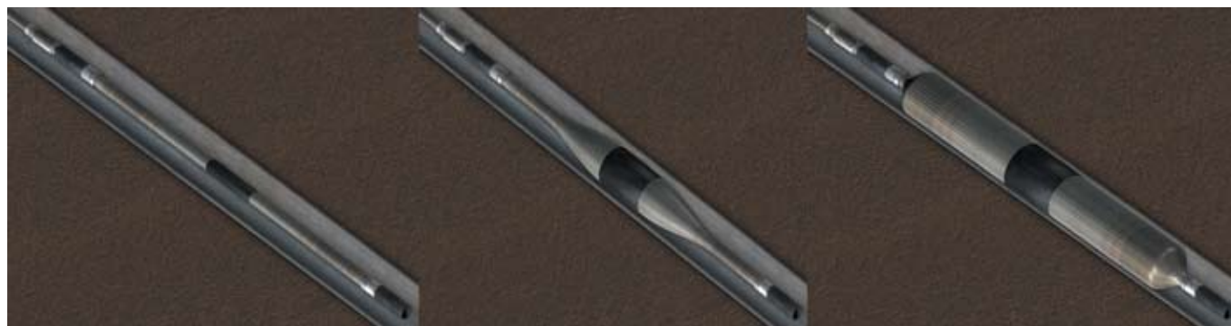
Рисунок 3 – CoilFLATE* – надувной пакер на ГНКТ (слева направо: спуск в скважину, процесс посадки пакера, полная посадка на ствол скважины)
