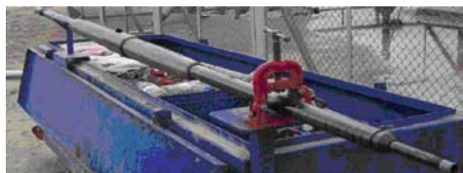
Рисунок 8 – CoilFLATE* пакер после подъема на поверхность
