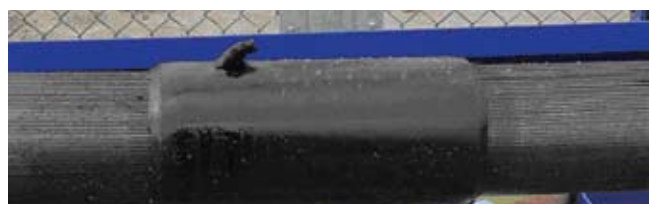
Рисунок 7 – CoilFLATE* изолирующий элемент со следами посадки на отверстия перфорации
