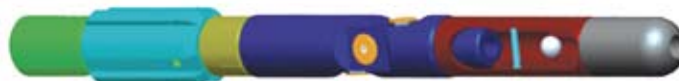
Рисунок 2 – Компоновка низа колонны ГНКТ – перфоратор AbrasiJET® Figure 2 – Coiled Tubing bottomhole assembly – perforator AbrasiJET®
