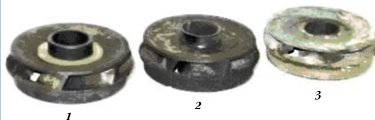
Рисунок 2а – Влияние очистки с применением ГТ на эксплуатационные качества ЭЦН. Номер 1 соответствует новому насосу, № 2 – насос из скважины, очищенной с помощью ГТ, № 3 – насос из скважины, очищенной традиционными методами
