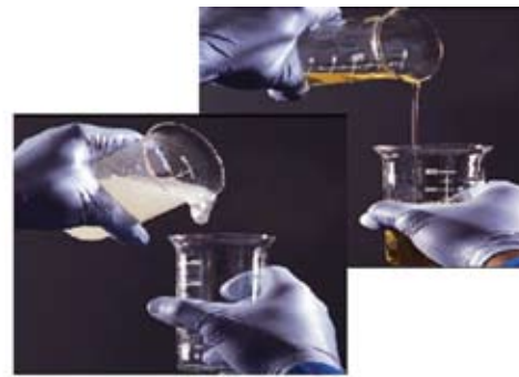
Рисунок 1 – Самораспадающиеся волокна J595 и вязкоупругая кислотная система VDA
