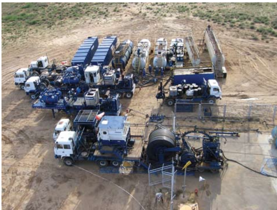
Рисунок 2 – Расстановка флота ГНКТ при проведении обработки Figure 2 – Coiled tubing fleet during the treatment
