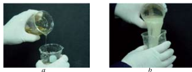
Рисунок 2 – Изменение вязкости кислотной системы VDA* при закачке в скважину (a) и в пласте при реагировании кислоты с породой (b) Figure 2 – Changing VDA* viscosity initially (a) and inside reservoir during acid spending (b)
