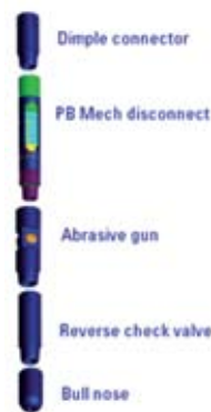
Рисунок 8 – Компоновка низа колонны для технологии AbrasiFRAC TT, сверху вниз – внешний коннектор (57 мм), механический разъединитель (54 мм), перфоратор (54 мм), обратный клапан (54 мм), полнопроходная насадка (54 мм)
