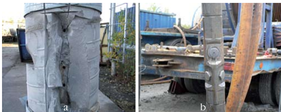
Рисунок 3 – Результаты проведения тестирования инструмента на базе: а) полученные отверстия и каверны; б) состояние форсунок и перфоратора после резки
