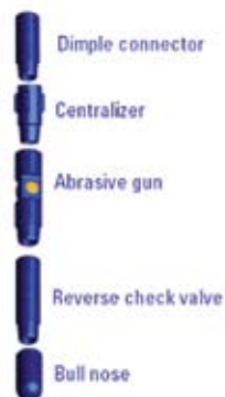
Рисунок 2 – КНК для абразивной резки через ЭК. Перевод текста сверху вниз: внешний коннектор; централизатор; абразивная насадка; обратный клапан; полнопроходная насадка
