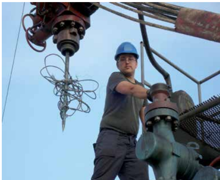
Рисунок 3 – Извлечение геофизического кабеля Figure 3 – Retrieving of logging cable
