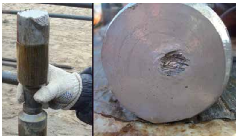
Рисунок 2 – Сленки извлекаемого оборудования на печати Figure 2 – Casts of retrievable equipment on the seal
