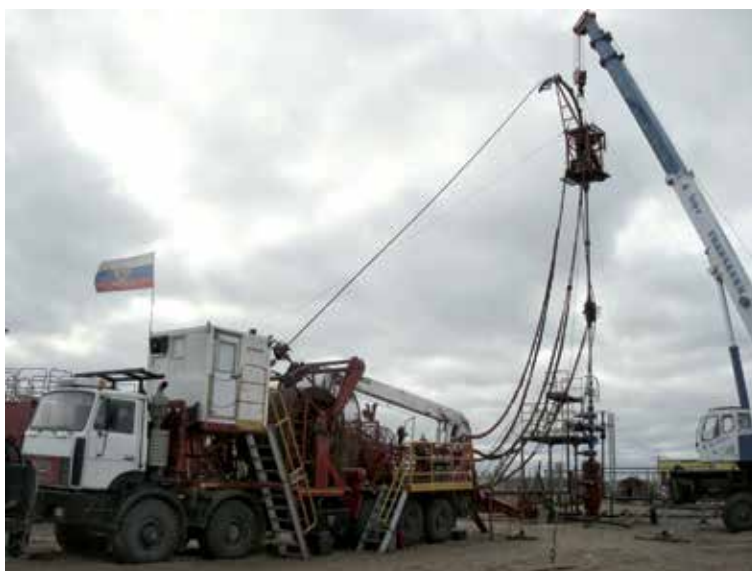
Рисунок 1 – Ловильные работы в незаглушенной скважине с применением колтюбинговой установки МК30Т-10
