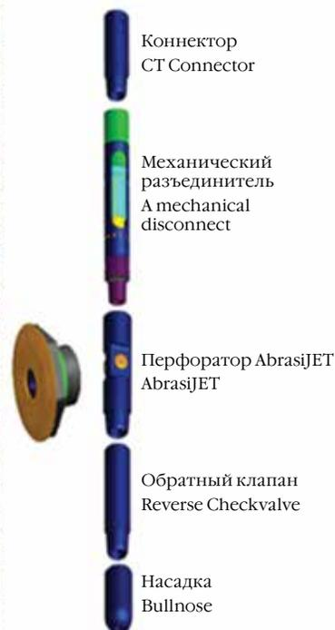
**Рисунок 1 – Компоновка низа колонны (КНК). КНК состоит из внешнего коннектора (2 1/4 дюйма (57 мм)), механического разъединителя (2 1/8 дюйма (54 мм)), перфоратора (2 1/8 дюйма (54 мм)), обратного клапана (2 1/8 дюйма (54 мм)) и полнопроходной насадки (2 1/8 дюйма (54 мм)).**
