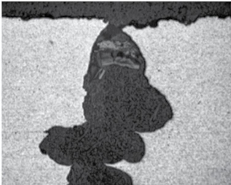
**Рисунок 1 – Коррозионная язва в стальном листе, вызванная колониями бактерий**
