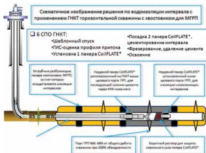
Рисунок 5 – Схема водоизоляции интервала с применением ГНКТ горизонтальной скважины с хвостовиком для МГРП
