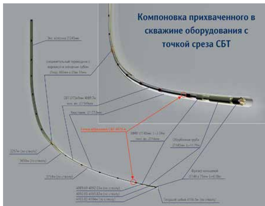
Рисунок 1– Компоновка прихваченного в скважине оборудования в точке среза СБТ
