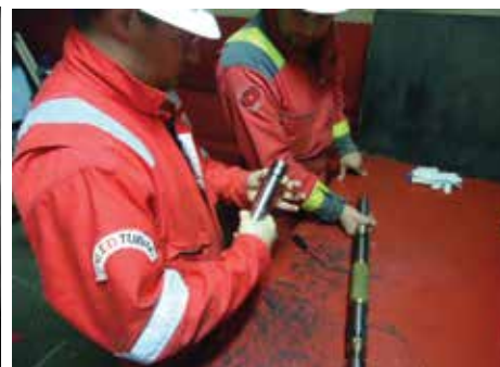
Сборка и тестирование камеры перед спуском на поверхность
