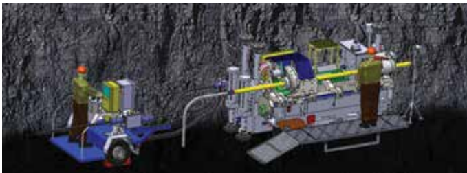
Рисунок 2 – Установка для направленного бурения скважин из шахтных выработок
