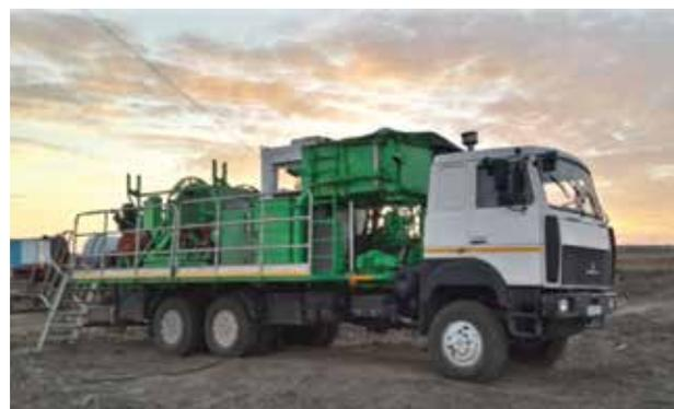
**Рисунок 1 – Установка для струйного вскрытия пласта СВП1**
