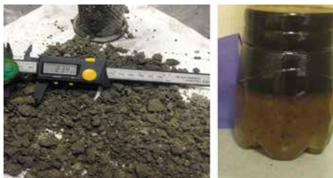
Рисунок 12 – Шлам, извлеченный из скважины шламоуловителем
