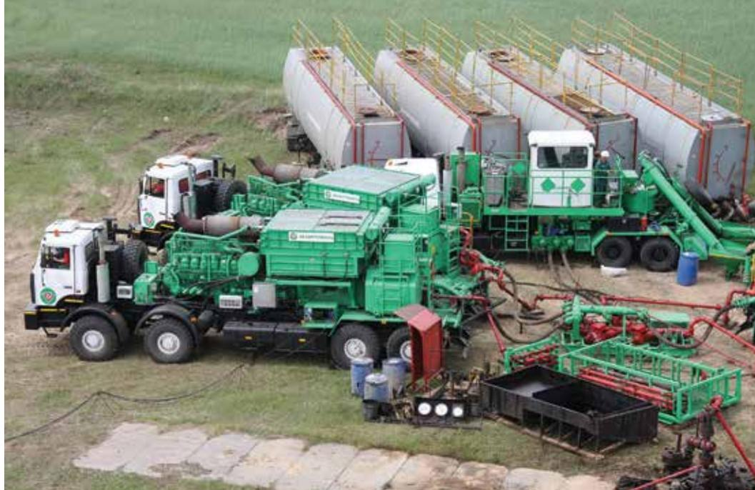
**Рисунок 1 – Компания «Белоруснефть» проводит ГРП с применением флота ГРП производства Группы ФИД**
