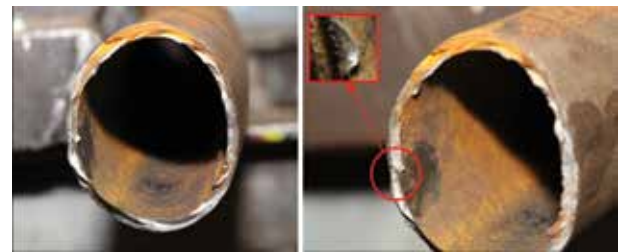
Рисунок 7 – Конечное состояние образца после проведения испытаний Figure 7 – Final state of the CT after the test
