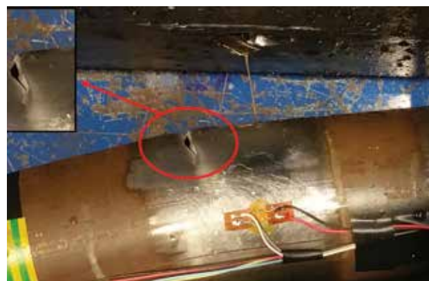
Рисунок 4 – Влияние растяжения и высокого внутреннего давления на образец
