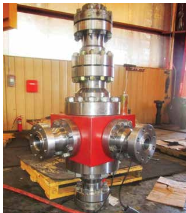
Рисунок 4 – Специальная устьева арматура FracGuard
