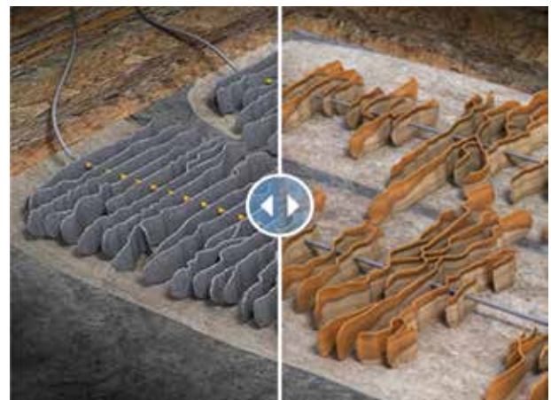
Рисунок 3 – Сравнение распределения трещин в горизонтальном стволе, слева технология «Premium Port + Jackal», справа стандартная технология МГРП Figure 3 – Comparison of fractures distribution along horizontal well, left «Premium Port + Jackal», right standard MSF technology
