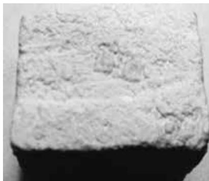
**Рисунок 6 – Образец поверхности модельного керна после моделирования взаимодействия разработанного замедленного кислотного состава при пластовых условиях**
