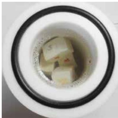
**Рисунок 5 – Образцы модельного керна для определения параметров кинетики растворения разработанного замедленного кислотного состава в жаропрочном коррозионно-стойком стакане высокотемпературного термохимического реактора**
