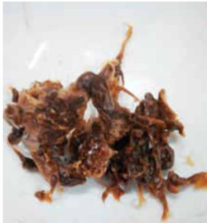
**Рисунок 3 – Образец деградировавшего при условиях фильтрации бурового раствора**
