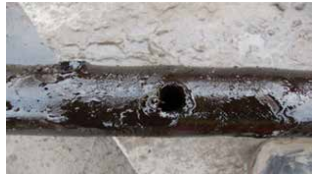
Рисунок 2 – Перфорационные заряды сработали полностью
