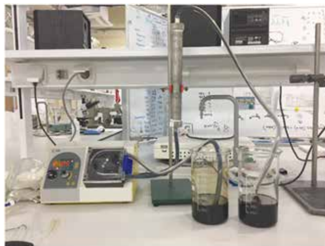
Рисунок 6 – Лабораторная установка для испытаний олеофильных (OF) полимерных матриц
