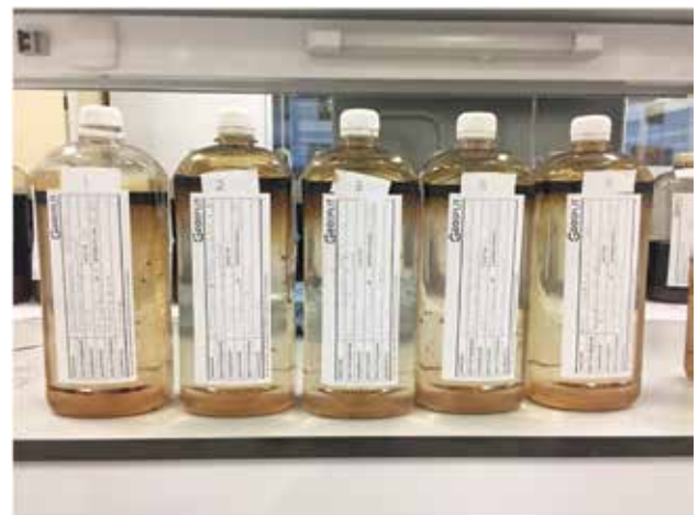
Рисунок 1 – Специализированная тара для отбора проб пластового флюида Figure 1 – Specialized packaging for sampling
