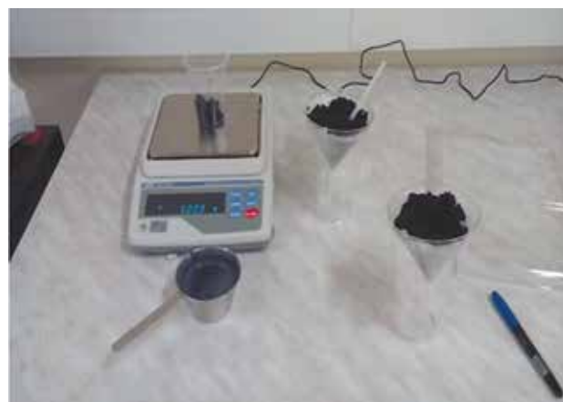
Рисунок 10 – Получение навесок образцов пропанта Figure 10 – GEOSPLIT proppant samples preparation
