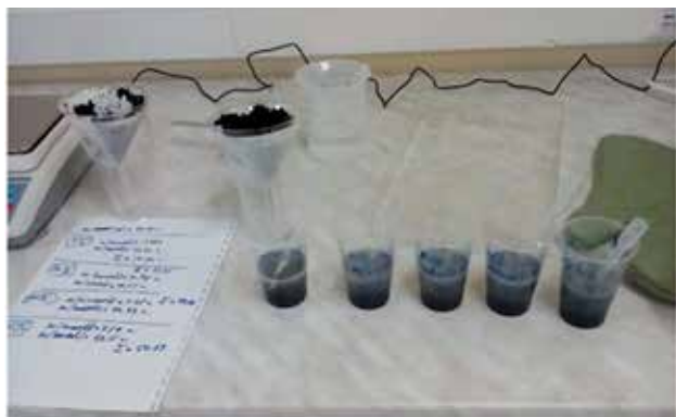
Рисунок 11 – Заливка образцов проппанта дистиллированной водой Figure 11 – Samples of polymer coated proppant with markers used for testing
