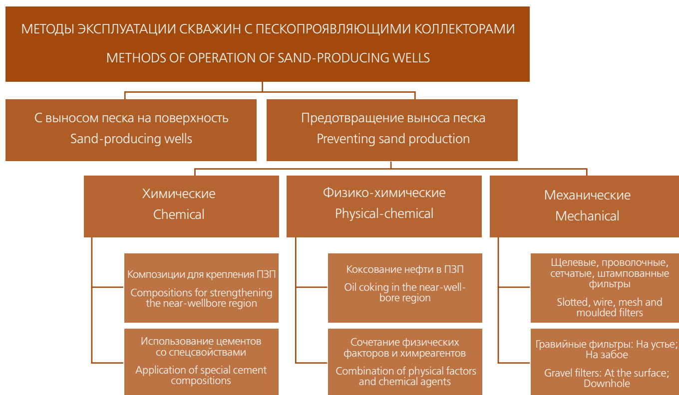
Рисунок 4 – Методы эксплуатации скважин с пескопроявляющими коллекторами Figure 4 – Methods of operation of sand-producing wells
