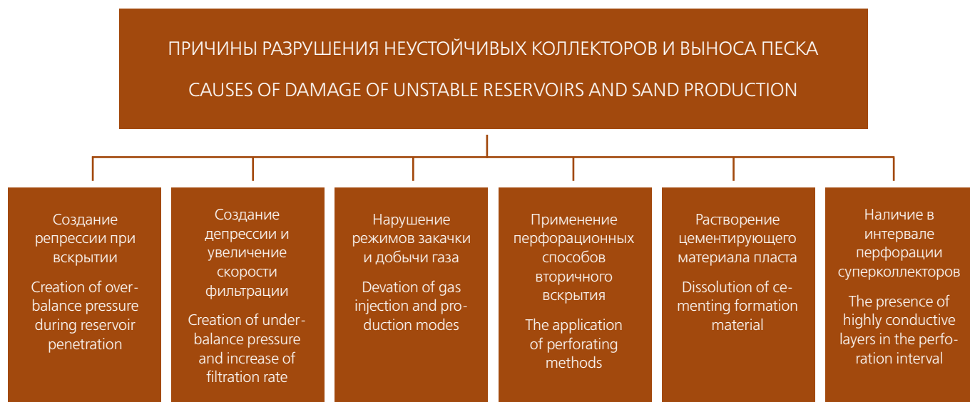
Рисунок 3 – Причины разрушения неустойчивых коллекторов и выноса песка Figure 3 – Causes of damage of unstable reservoirs and sand production
