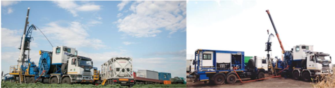
СЗАО «ФИДМАШ» была поставлена подобная колтюбинговая установка МК-30Т-10 на базе шасси МЗКТ с тяговым усилием инжектора 27 тонн, которая выполняет сервисные работы за рубежом.
