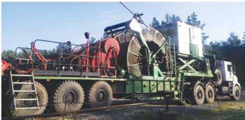
технологические операции: промывку насосно-компрессорных труб (НКТ) и забоя скважины (обеспечение дохождения приборов до интервала исследований); исследование скважины с вызовом притока (закачка азота).
