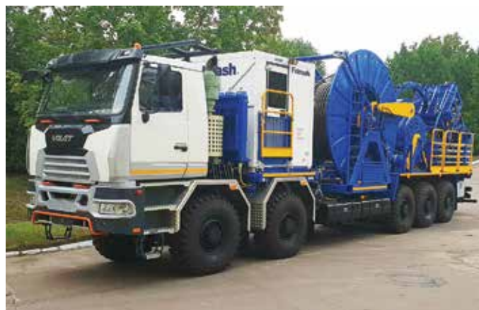
Колтюбинговая установка МК30Т-50 CT unit MK30T-50
