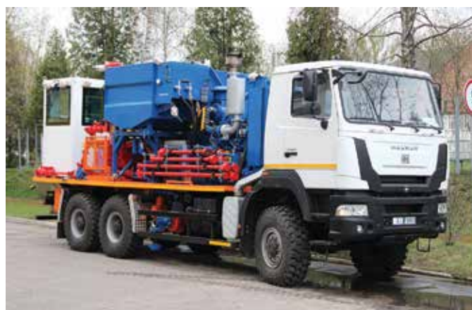
Установка насосная H505 Pumping unit H505
