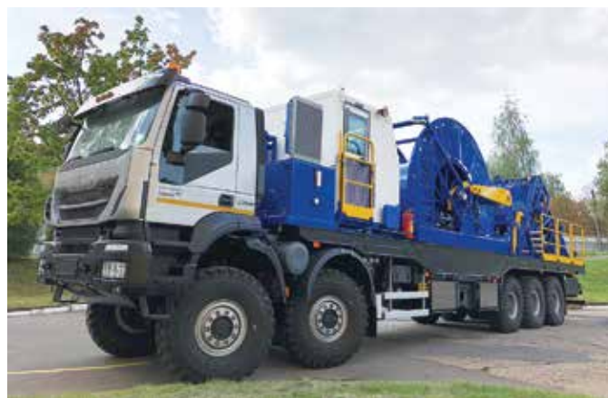
Колтюбинговая установка МК40Т CT unit MK40T
