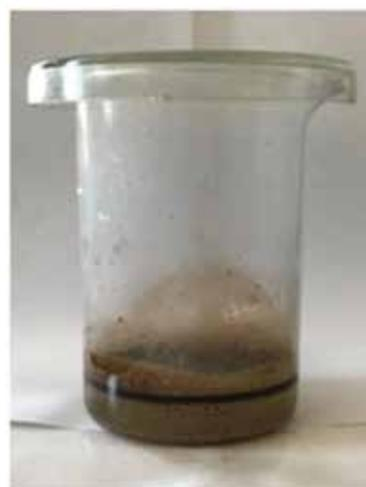
**Рисунок 3 – Вид разделенной КАЭ после тестирования на ее распад при добавлении карбоната кальция в течение 30 минут при температуре 95 °С**
