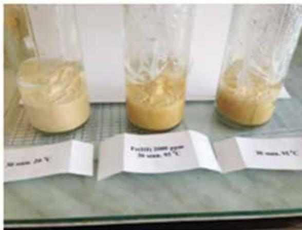
**Рисунок 2 – Вид баночек после тестирования КАЭ на стабильность в течение 30 минут при температуре 95 °С с добавлением сверху воды**
