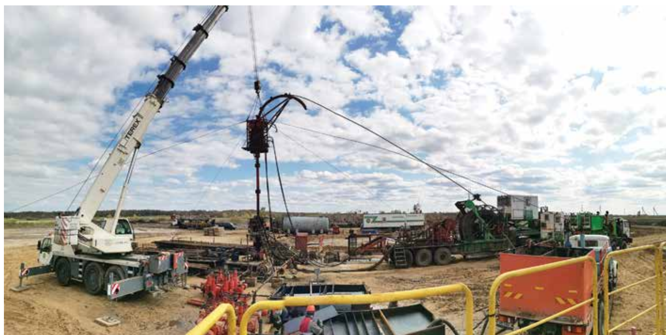
Рисунок 1 – Применяемое оборудование в процессе фрезерования композитных пакер-пробок после Plug & Perf
