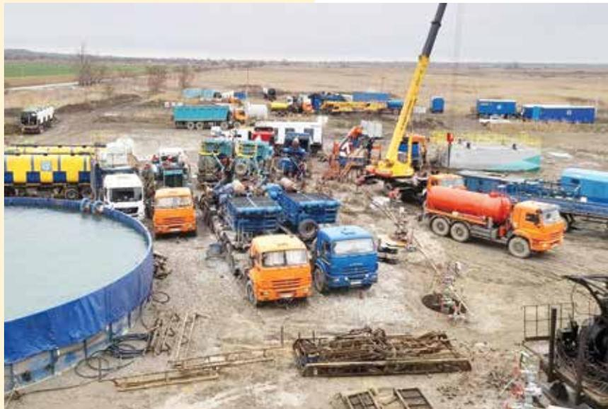
Технология многостадийного ГРП позволяет увеличить площадь дренирования скважинной продукции. Он применяется на горизонтальных скважинах с низкопроницаемыми, неоднородными коллекторами и заключается в создании нескольких зон трещиноватости перпендикулярно горизонтальному стволу. Количество стадий ГРП зависит от длины ствола и напрямую влияет на конечную продуктивность скважины.
