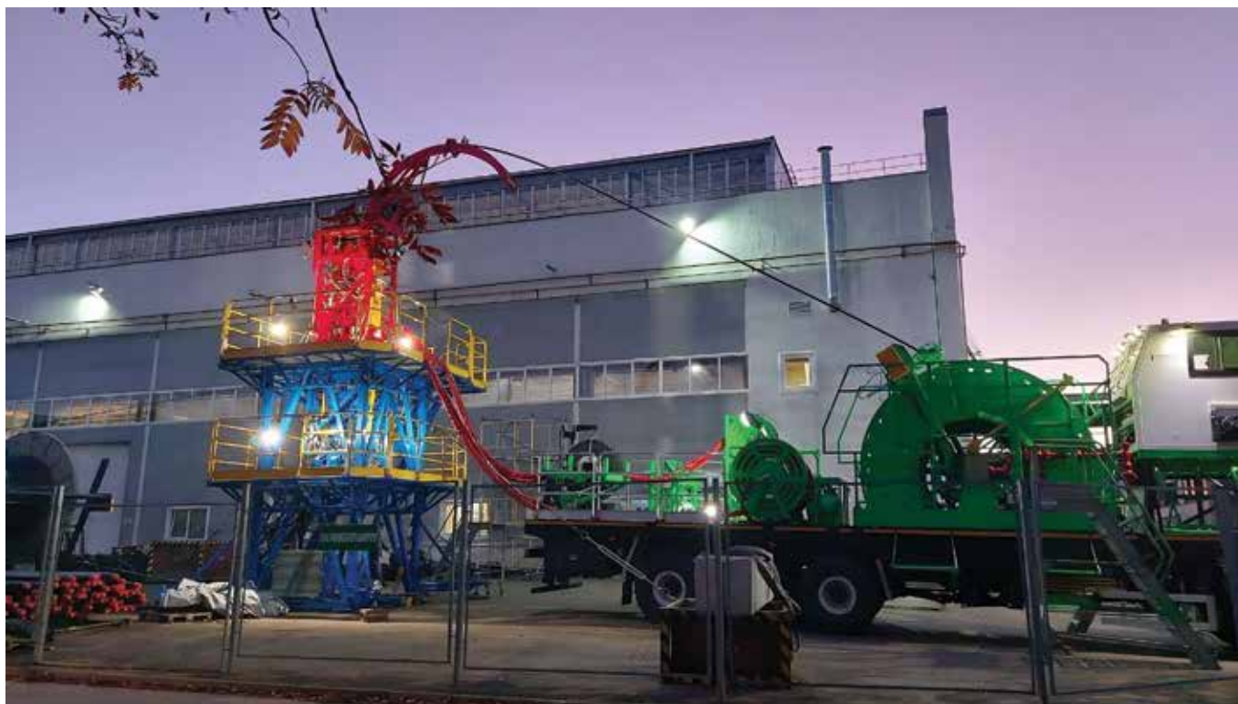
Стенд динамических испытаний колтюбинговых установок
