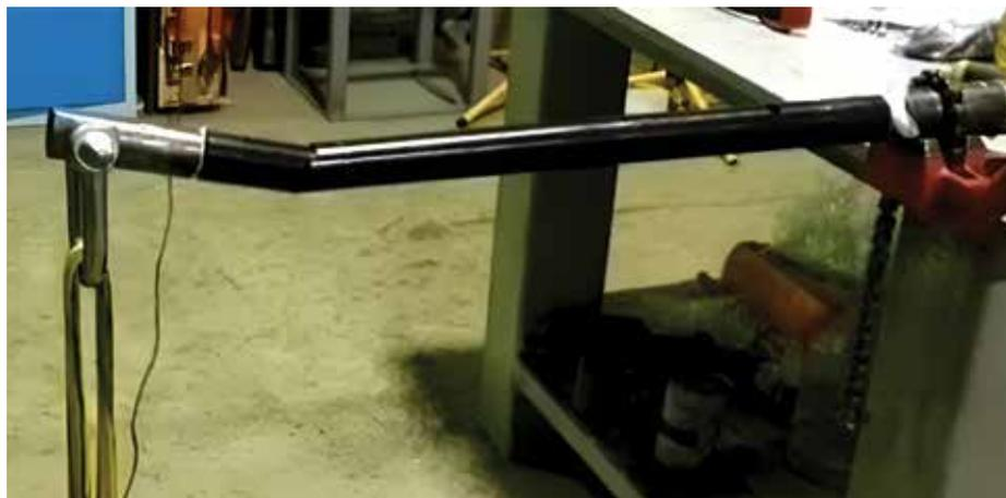
**Рисунок 2 – Стендовые испытания гидрокотклонителя с нагрузкой**
