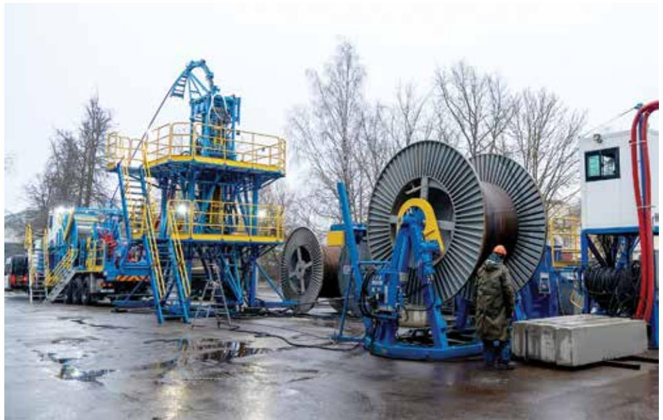
*Стенд динамических испытаний коiled tubing установок
