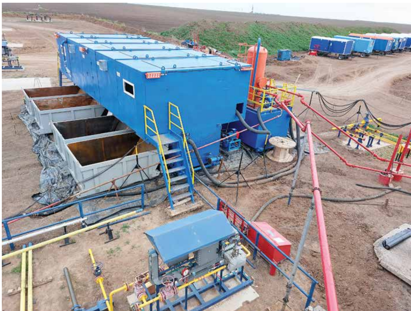
Рисунок 2 – Циркуляционная система с линиями обвязки Figure 2 – The circulation system and the manifolds
