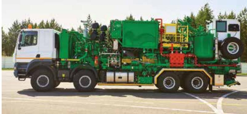
Установка предназначена для приготовления тампонажного раствора и его контролируемой закачки под давлением в скважину при цементировании, а также при проведении других промывочно-продавочных работ на нефтяных и газовых скважинах.
