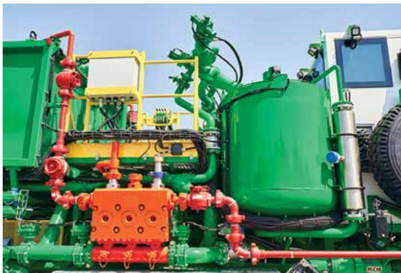
В средней части установки расположена подпиточная емкость, которая разделена на два отсека одинакового объема (2,3 м<sup>3</sup>), что позволяет обеспечить работу с различными технологическими жидкостями.
