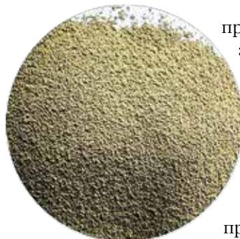
**Проппант всегда подбирают под определенную скважину. Чем выше проницаемость самого пласта, тем крупнее должен быть проппант.**
