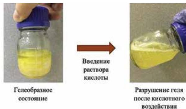
**Рисунок 1 – Консистенция отклонителя до и после разрушения кислотой [2]**
