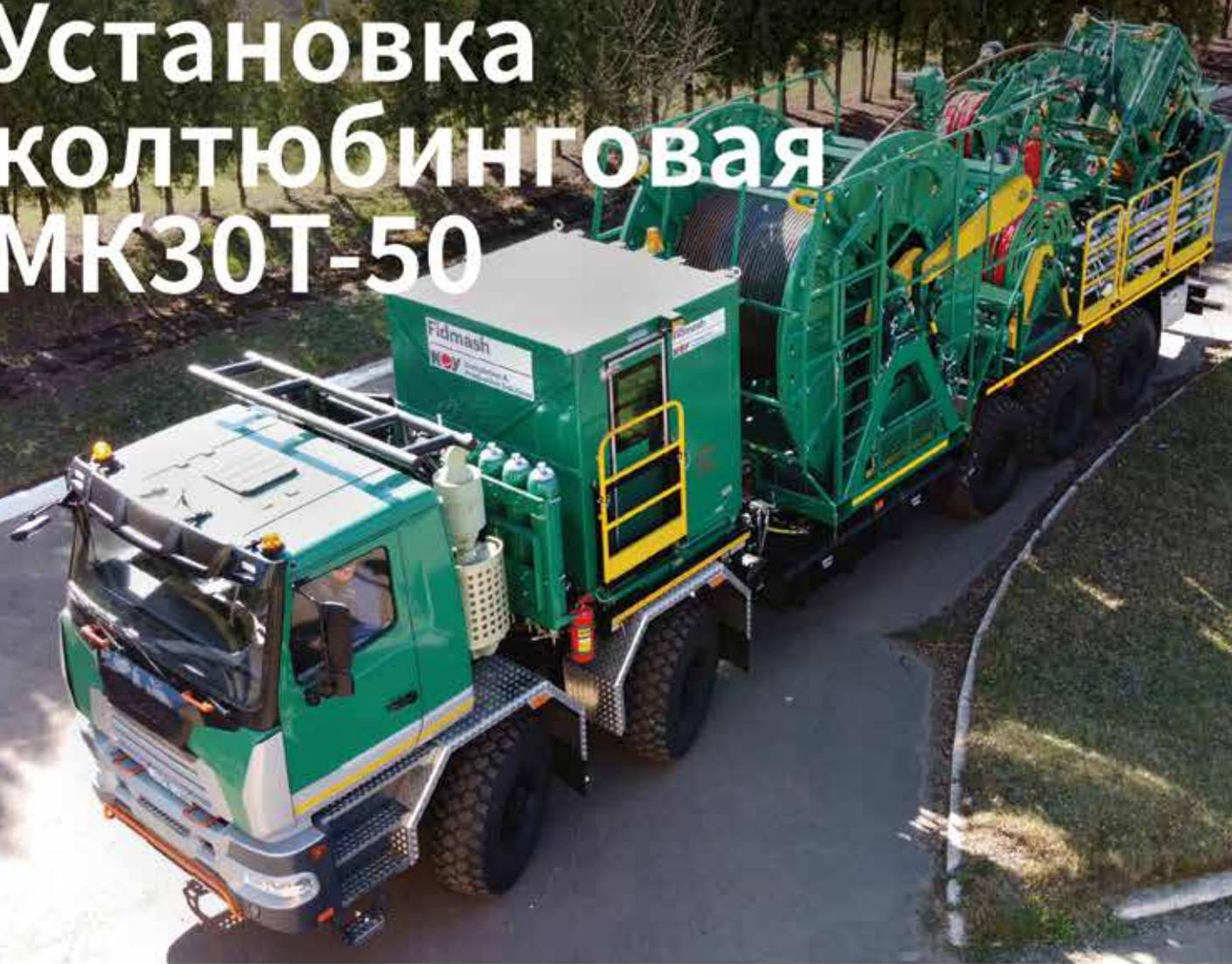
Установка колтюбинговая МК30Т (МК30Т-50) производства СЗАО «ФИДМАШ» смонтирована на полноприводном шасси (10x10) и представляет собой полный комплект оборудования для работы с безмуфтовой длинномерной трубой (БДТ). Предназначена для БДТ диаметром 44,45 мм, но может также работать с БДТ диаметром 50,8 мм. Зимний пакет и кондиционеры в обеих кабинах.
