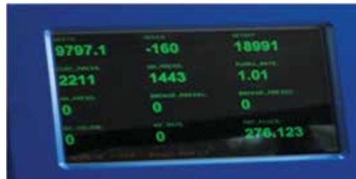
**Рисунок 3 – Пример монитора записи рабочих параметров, где первичный спуск в скважину проводят на скоростях более 160 фут/мин, что соответствует 48,7 м/мин**
