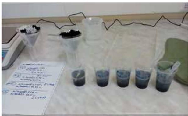
**Рисунок 11 – Заливка образцов проппанта дистиллированной водой**
