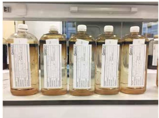
**Рисунок 1 – Специализированная тара для отбора проб пластового флюида**
