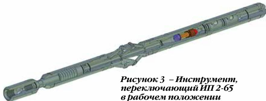
**Рисунок 3 – Инструмент, переключающий ИП 2-65 в рабочем положении**
