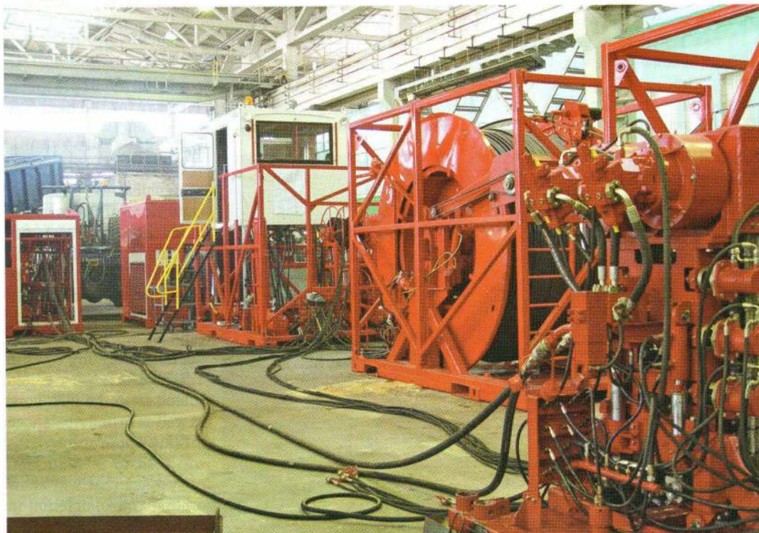
Колтюбинговое оборудование для ремонта скважин с морской платформы Coiled Tubing equipment for offshore platform workover operations
