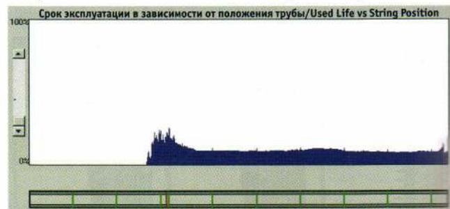
Рис. 14. Колтюбинговая колонна с удаленным участком с чрезмерным усталостным повреждением и позднее отремонтированная посредством приваривания участка
